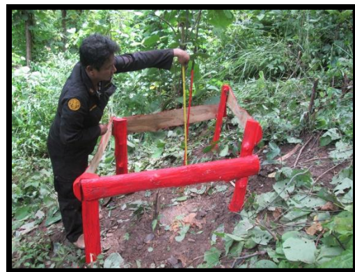
ภาพการตรวจวัดการพังทลายของดิน ในพื้นที่สวนป่าแม่สิน-แม่สูงและนาพูน
