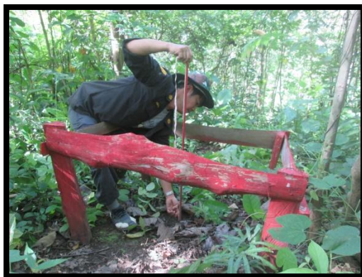
ภาพการตรวจวัดการพังทลายของดิน ในพื้นที่สวนป่าแม่สิน-แม่สูงและนาพูน
